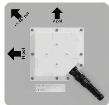
Notare nella condizione "Dual Slant", ovvero con polarizzazioni incrociate, come gli apparati debbano essere ruotati per allineare correttamente. Questo caso si verifica soprattutto nelle installazioni P-MP dove la Base station è dotata di antenne Dual-Slant. In tal caso il client dovrà essere ruotato di 45°, il connettore ethernet verrà a trovarsi nella parte inferiore rivolto verso terra.
