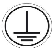
Si ricorda di collegare l'armadio ad una terra efficace con un cavo di sezione adeguata (4-6 mm.) con la minor lunghezza possibile. Utilizzare possibilmente un pozzetto con picchetto di messa a terra saldamente ancorato al terreno.
